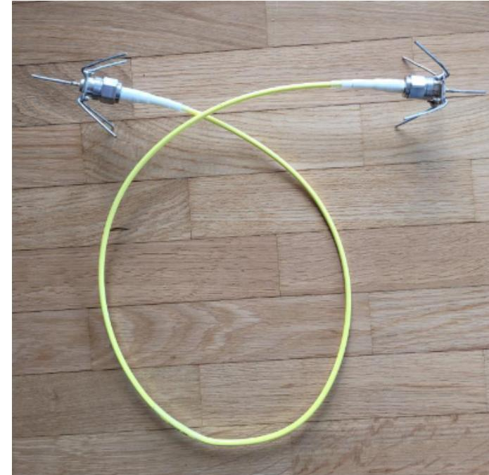
Un répéteur passif est constitué de deux antennes et d'un cordon RF (figure ci-dessous). La première antenne permet de « capter » le signal WIFI du bâtiment (là où est localisé le routeur). Le signal est ensuite dirigé vers l'antenne de l'atelier via le cordon RF. L'antenne de l'atelier permet de réémettre le signal WIFI dans l'atelier. Le système est passif, car aucun élément actif est utilisé (comme un amplificateur).
